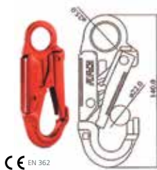
CE EN 362 LX04 Snap Hook Forged Steel. MBL: 22kn
